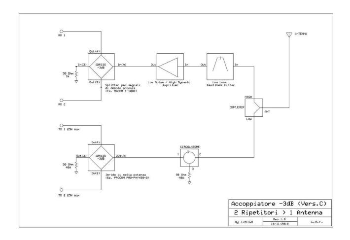
La seconda versione, potremmo definirla "DE LUX", che analizzeremo principalmente a scopo didattico, è in pratica la soluzione ideale adottata dai sistemi professionali multi accesso, come la telefonia mobile ecc. che permette di annullare l'attenuazione del segnale introdotta dal dispositivo.
